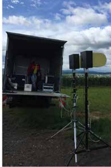
Emulator des Senders des Küstenradars (links) und die zwei Antennen des Passivradars, die langfristig auf den Drohnen angebracht werden sollen (rechts).
